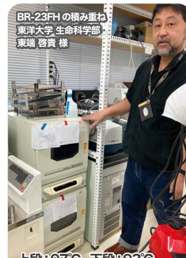
BR-23FHの積み重ね 東洋大学 生命科学部 東端 啓貴 様 上段:97℃、下段:93℃ など温度を変えて好熱菌の培養に 使用されています。
