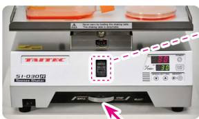
SI-030Rの傾斜角調整ダイヤル（矢印）と確認窓
