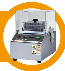
ステンレス製強力破砕容器を用いたプラスチック試料の凍結破砕
